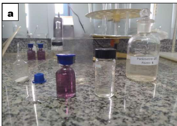
Figura I.1 - Amostras de OD, da estação FOR05, do período chuvoso (a) e período chuvoso (b), preservadas para serem analisadas no espectrofotômetro (c)
