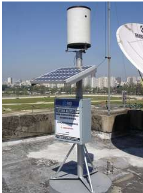
Figura 14 – Pluviômetro do Jardim Botânico do Sistema Alerta Rio
