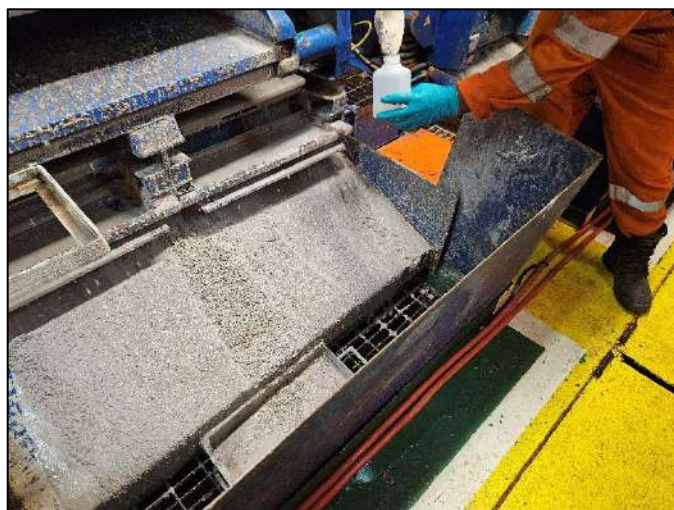
Figura 14 — Registro da coleta de amostra de cascalho (Casc_A) em um dos poços amostrados
