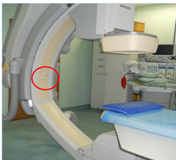
Figura 13: Local onde o dosímetro de referência é posicionado.
