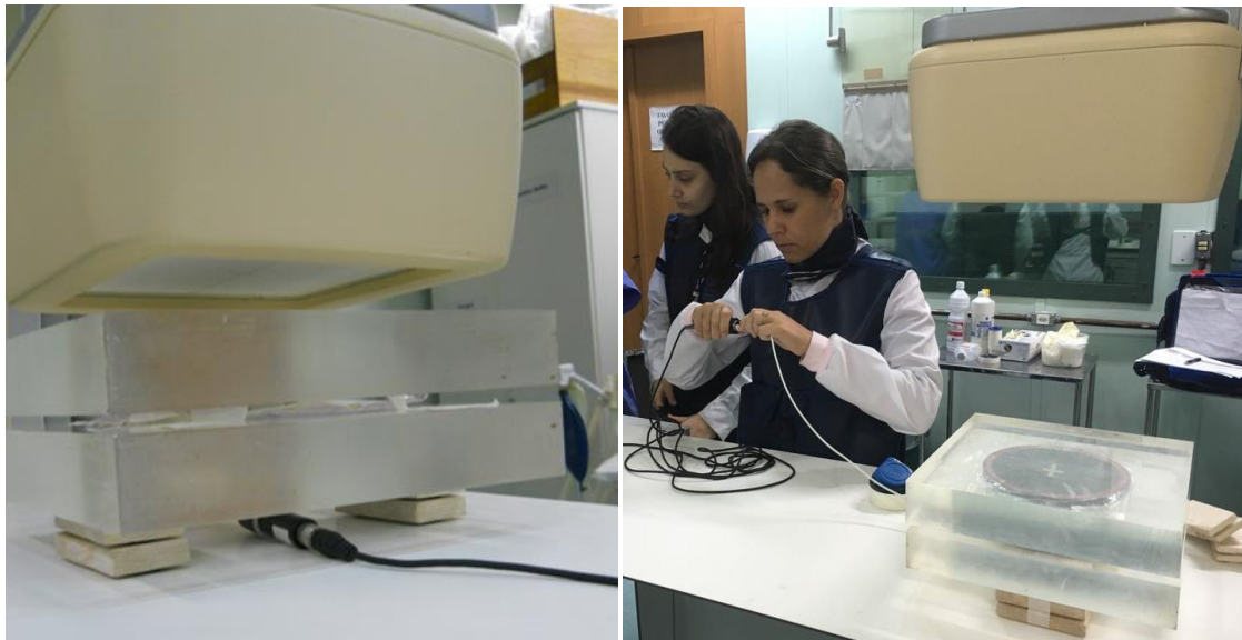
Figura 10: Arranjo experimental para os testes de taxa de kerma no ar na superfície de entrada e da imagem. Imagens: L. Canevaro.
