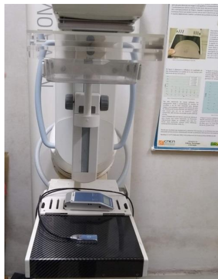
Figura 18: Aparato experimental para obter-se os valores de kerma no ar incidente, na DIFME/IRD em 14/04/2022.
