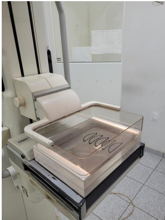
Figura 20: Aparato experimental para as medidas da CNR, simulando uma espessura de mama equivalente a 4,5 cm, na policlínica SASE Realengo, em 12/05/2023.
