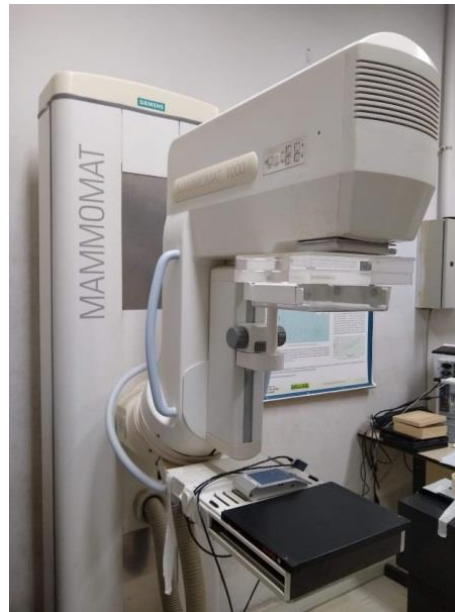
Figura 17: Aparato experimental para obter-se as imagens referentes à linearidade de resposta do detector, na DIFME/IRD em 14/04/2022.
