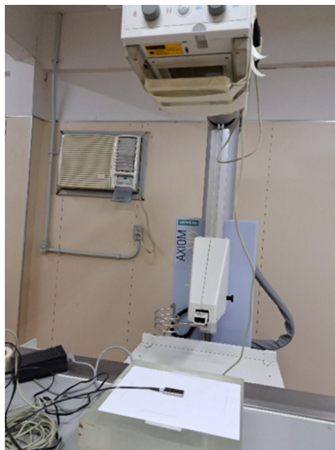
Figura 29 – Arranjo experimental para medição dos valores de kerma no ar a serem utilizados no procedimento de calibração dos OSLD2.
