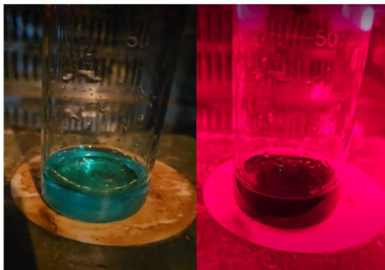
Figura 60. Fotossensibilizante ftalocianina de zinco sem incidência de luz no reator (foto da esquerda) e com incidência de luz vermelha no reator (foto da direita).
