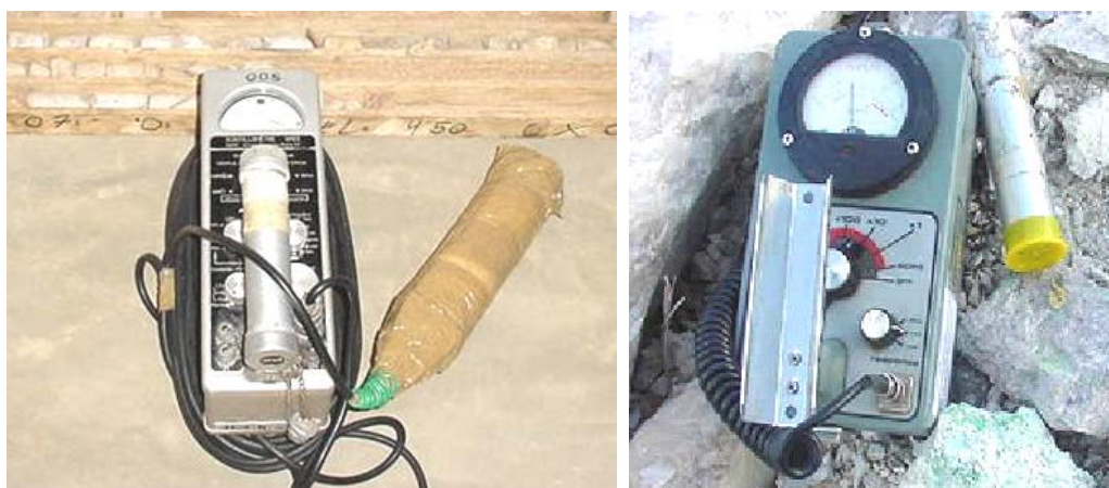
Figura 15 – Cintilômetro Saphimo SPP-3 com cabo de 20 metros e leitura em CPS (esquerda) e Medidor de taxa-de-exposição, Monitor Thyac, leituras em R/h (direita).
