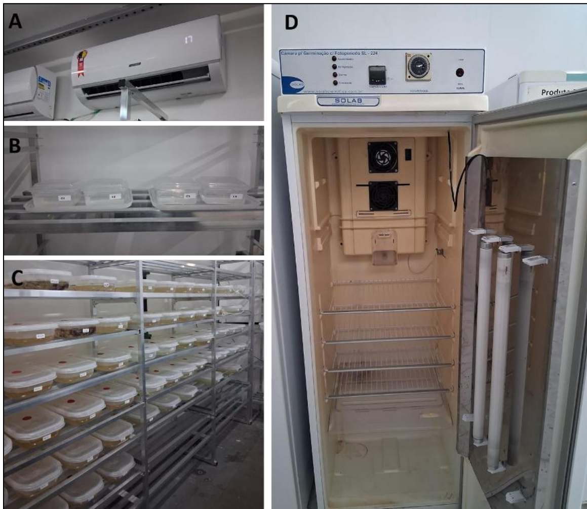
Fig. 7. Experimento de temperatura. A–C Sala climatizada do controle. A. Ar condicionado. B. Disposição dos recipientes contendo as réplicas do controle. C. Recipientes do cultivo para manutenção de P. dumerilii . D. Incubadora utilizada nos tratamentos de temperatura.
