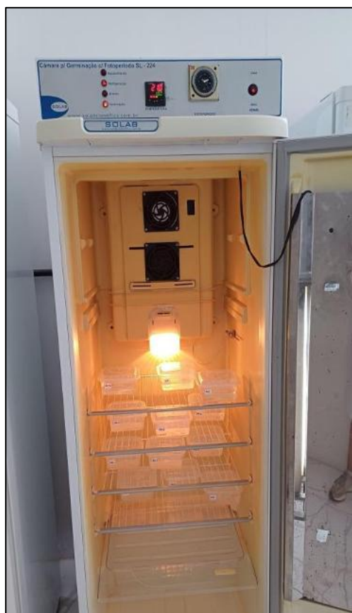
Fig. 5. Distribuição dos recipientes do experimento de salinidade em incubadora.
