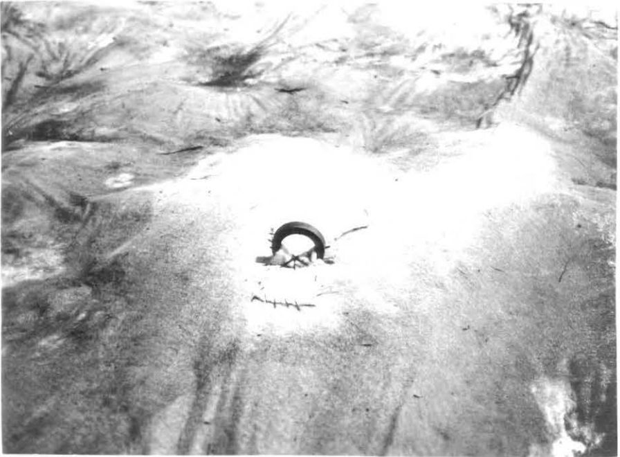
Foto 8 - Detalhe do Alvo Magnético Instalado na Manta Geotêxtil.
