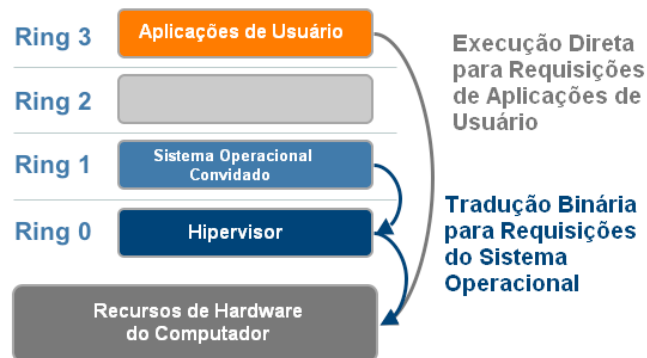
Figura 4 – Arquitetura do Processador na Virtualização Total [VMWARE1, 2007]
