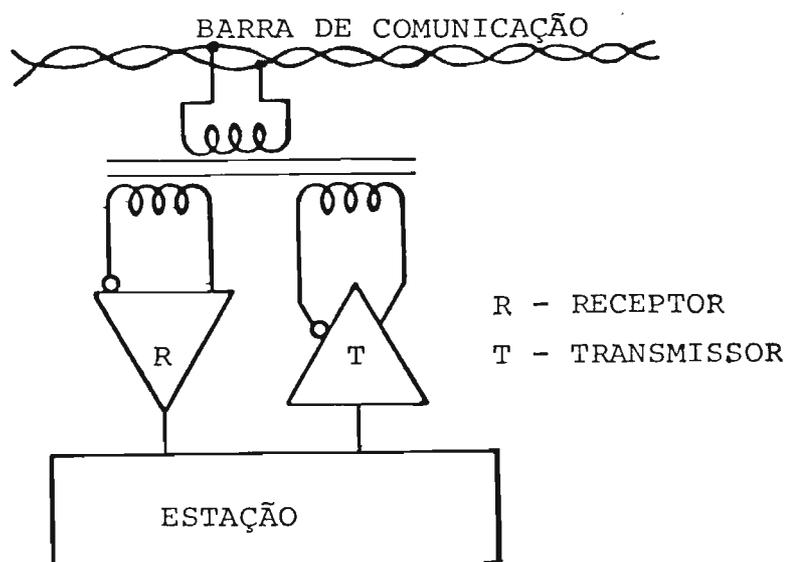
FIGURA 7: CONEXÃO DA ESTAÇÃO À BARRA
