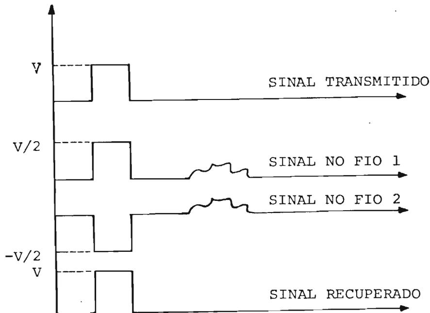
FIGURA 6: UTILIZAÇÃO DE CIRCUITOS DIFERENCIAIS
