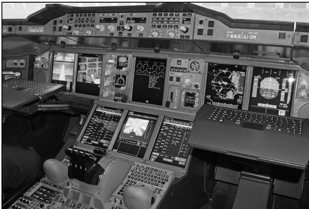
Figura 15 - Flight Deck do A380 e seus aviônicos
