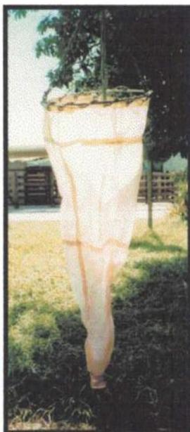
Fig. 13 - Rede de plâncton do tipo cônica utilizada durante as coletas (Foto do autor).
