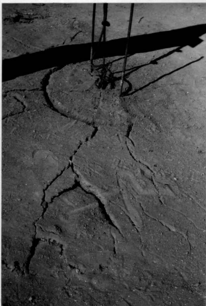
Foto VI.7 - Ensaio 12 ( B=30\text{cm} , D=45\text{cm} ). Observe-se como as trincas se estenderam fora dos limites da escavação. Nessa ruptura a área envolvida foi de, aproximadamente, 3.14\text{ m}^2 . (A área da escavação é de 0.283\text{ m}^2 ).
