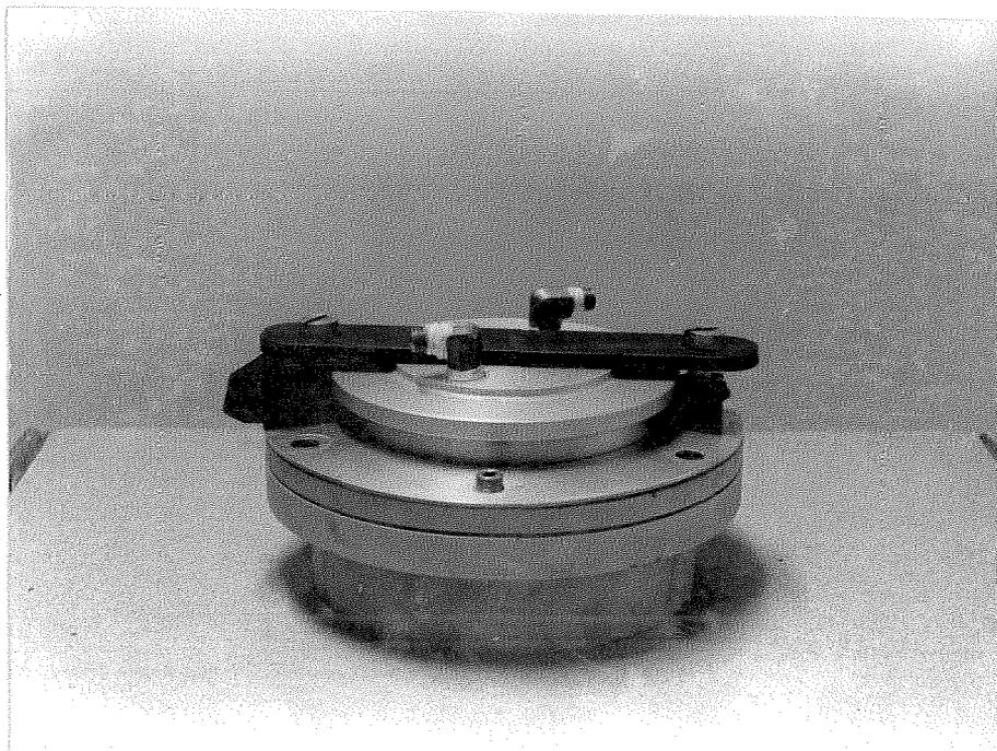
FOTO V.8—ASPECTO GERAL DA MONTAGEM DA CÉLULA DE ADENSAMENTO.
