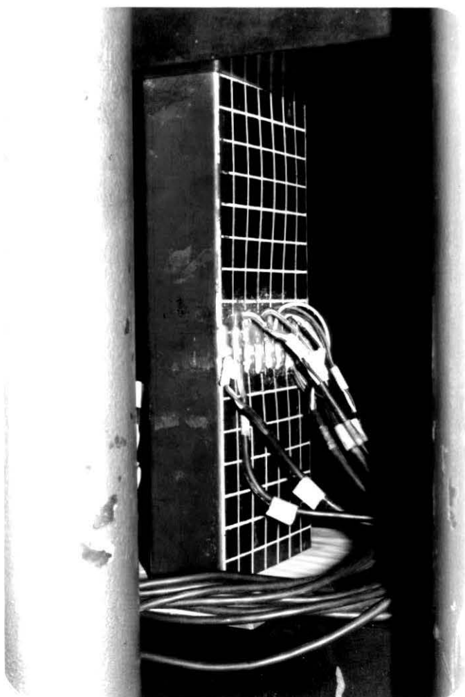
foto III.2 - Corpo de prova CP1-S1 posicionado na máquina de ensaios. Em destaque os extensômetros elétricos fixados à meia altura do corpo de prova
