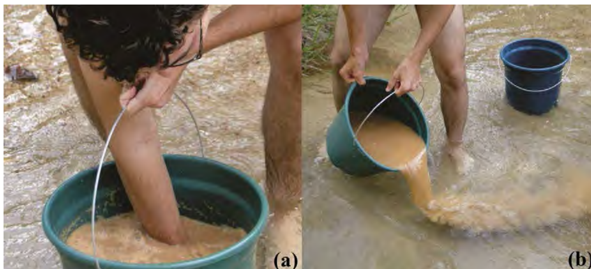
Figura 4 – Deslamagem do saprólito na drenagem. a – Homogeneização da amostra em água; b – Eliminação da argila e do silte.
