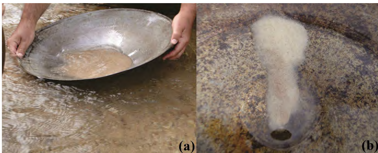
Figura 6 – Utilização da bateia para concentração gravimétrica dos minerais pesados. a – Início do processo com o material menor que 2 mm separado com o uso da peneira; b – Concentrado parcial.
