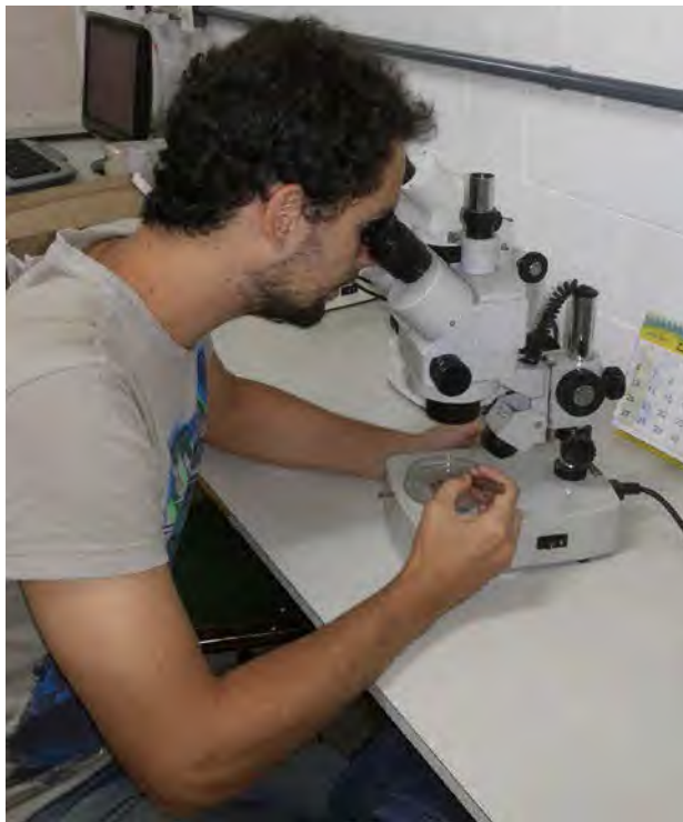
Figura 10 – Análise e separação dos minerais de interesse em estereomicroscópio.
