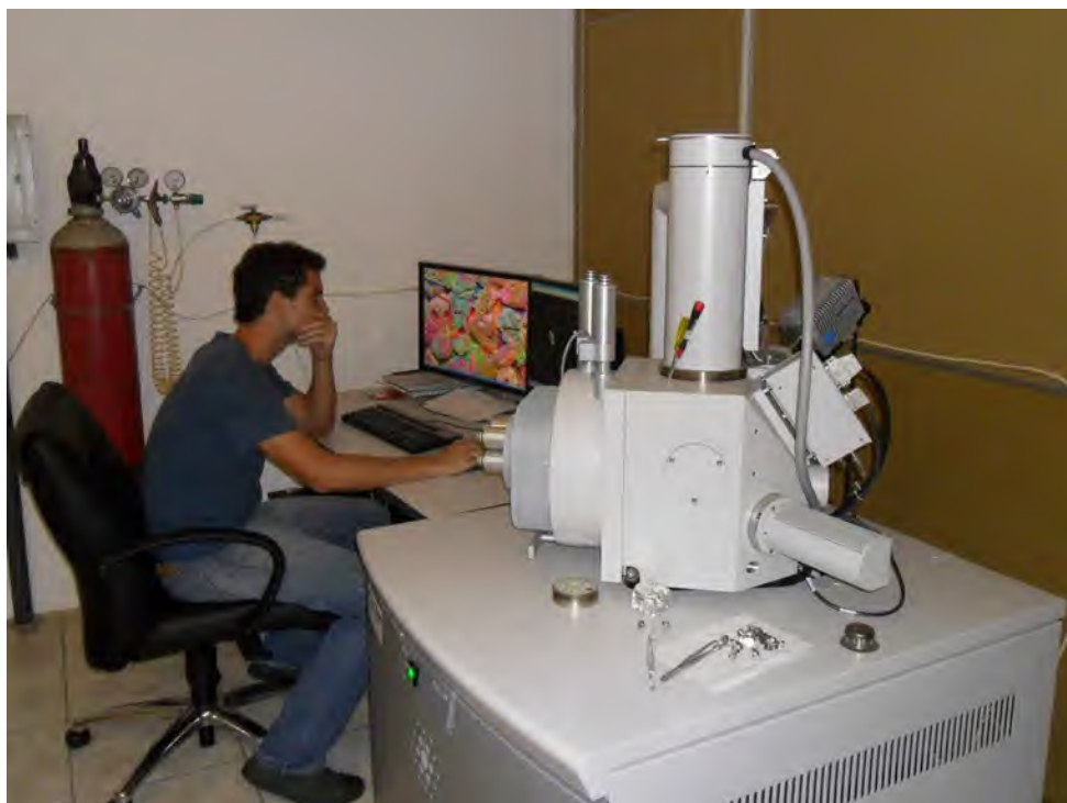
Figura 12 – Microscópio eletrônico de varredura com microanálise por dispersão de energia (MEV-EDS) do Centro de Tecnologia Mineral (CETEM) onde foi realizado o estudo.
