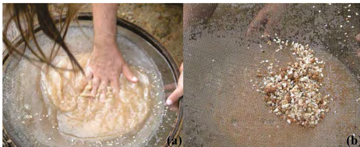
Figura 5 – Separação granulométrica com peneira. a - Processo de peneiramento para a retirada do material menor que 2 mm. ; b - Resíduo maior que 2 mm.
