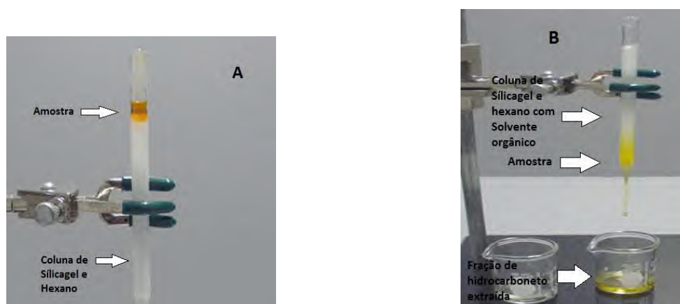
Figura 5. A - Fracionamento do Extrato Orgânico por Cromatografia líquida; B – obtenção da fração do Hidrocarbonetos.
