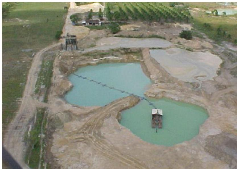
Figura 5 – Extração de areia em cava por dragagem em planície aluvionar.
