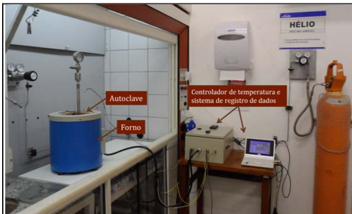
Figura 3 Foto do sistema de hidropirólise do Laboratório de Palinofácies e Facies Orgânica (LAFO), UFRJ.
