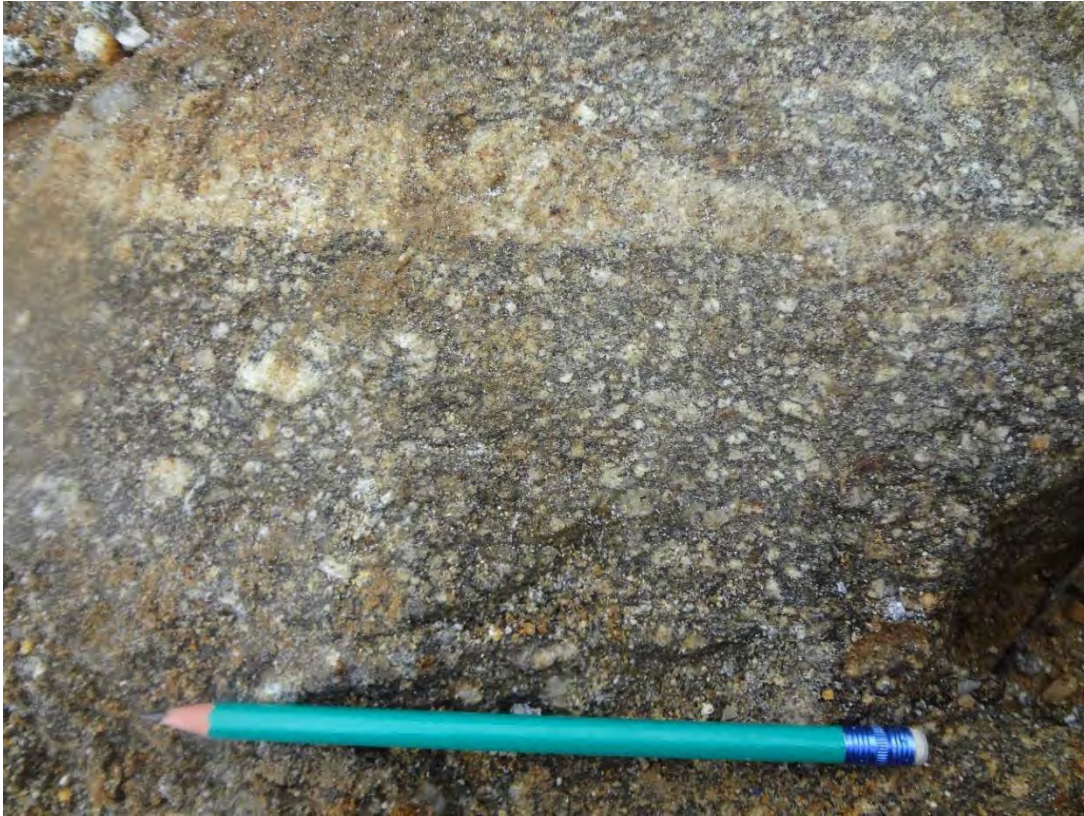
Figura 10: Foto de bloco do Gnaiss Cassorotiba com fenocristais de feldspato, mesocrática, apresentando uma textura isotrópica, granulação média e feldspatos amendoados (PF-24b).
