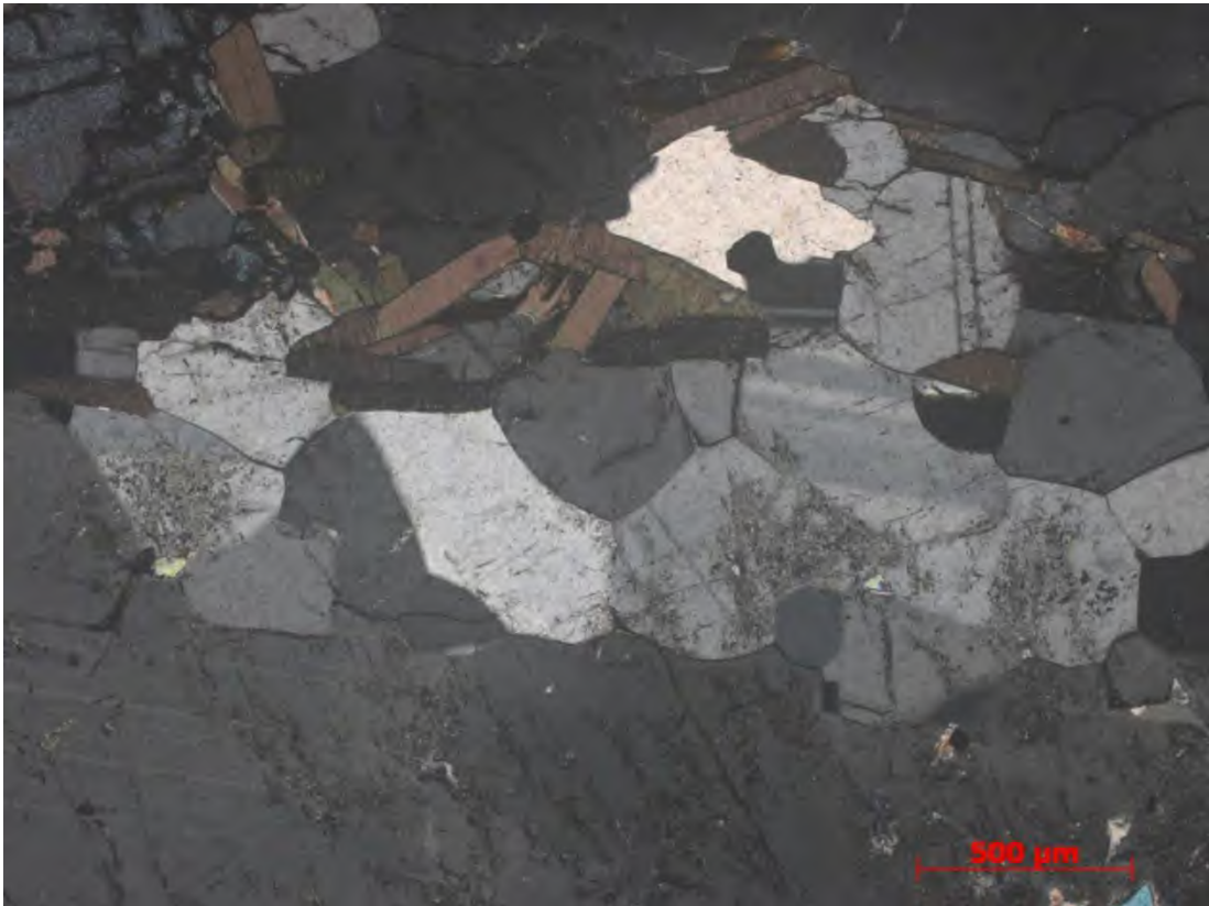
Figura 36: Fotomicrografia de cristais de quartzo e plagioclásio com hábito granular e contatos poligonais (Lâmina PF-33D Nx).
