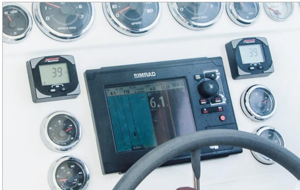
Figura 4 – Display do aparelho SIMRAD NSS7, montado na lancha Iamany, destaque para a divisão da tela em duas partes: à esquerda encontram-se as linhas de aquisição importadas no aparelho, por cima das quais o condutor guia a embarcação durante a aquisição de dados. À direita, a imagem do recurso StrataScan, adquirida em tempo real, mostrando feições texturais do fundo, assim como a profundidade local.
