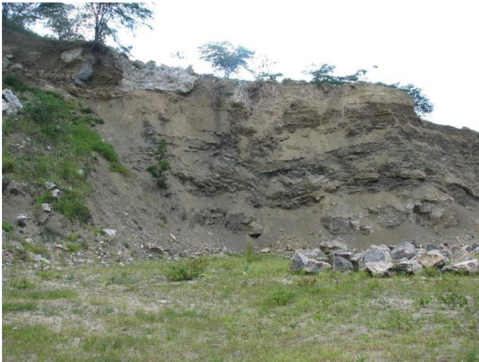
Figura 27 - Organização da frente de lavra da mina Conceição Preta, onde ocorrem dois pacotes de evaporitos separados por camadas arqueadas.
