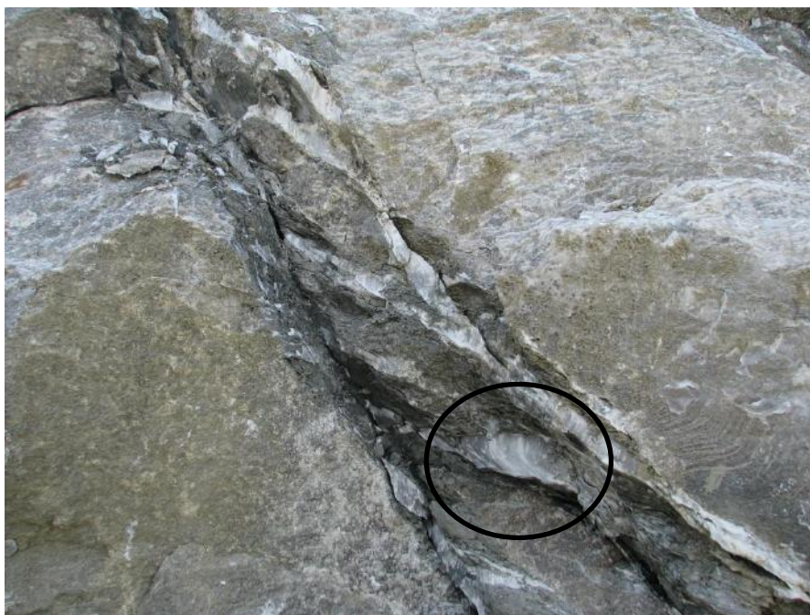
Figura 58 - Fibras de espato acetinado dobradas, em destaque, ocorrendo em veio na Mina Pedra Branca.
