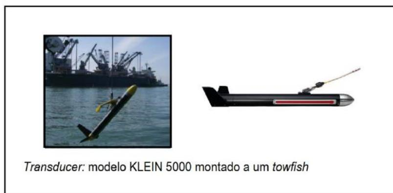
Figura 10: (Acima) Foto mostrando a instalação da antena (transducer) utilizada em campo no presente trabalho. (Abaixo) Exemplo de equipamentos em configuração de reboque.
