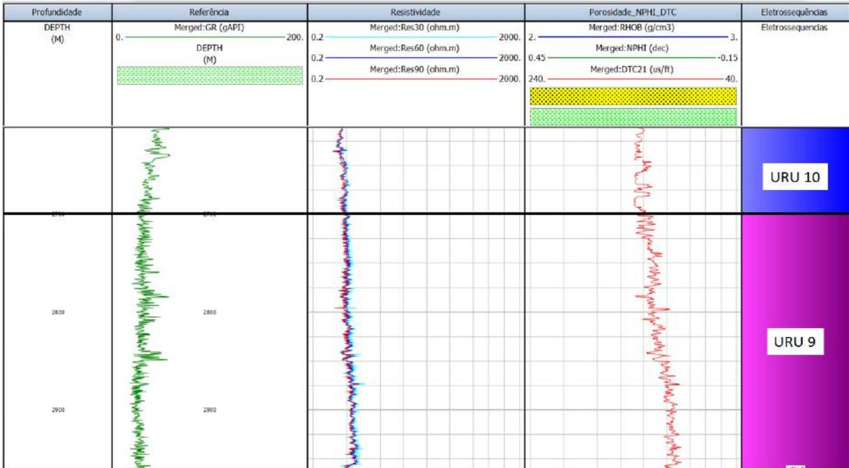
**Figura 19** – Interpretação da Eletrossequência URU 9, a partir do poço chave 1-BRSA-789-ESS. A URU 9 apresenta-se com menos oscilações, além de um progressivo aumento do perfil Sônico e Raios Gama até o limite com a URU 10, e uma leve diminuição do perfil de Resistividade.
