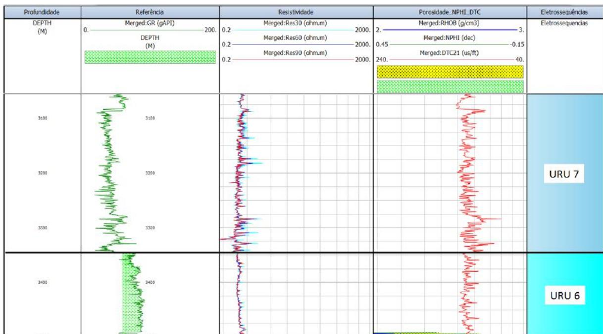
**Figura 16** – Interpretação da Eletrossequência URU 6, a partir do poço chave 1-BRSA-789-ESS. A URU 6 segue padrão contínuo e com menos oscilação em relação a URU 7, sendo a principal diferença visual entre as duas eletrossequências, com diminuição dos valores de todos os perfis geofísicos, caracterizado por um marco elétrico, realçado por uma linha em preto.
