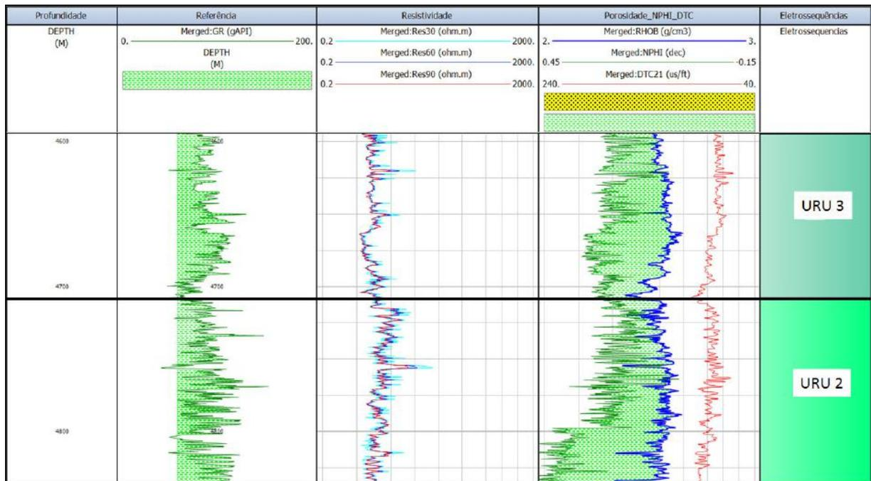
**Figura 12** – Interpretação da Eletrossequência URU 2, a partir do poço chave 1-BRSA-789-ESS. A URU 2 mostra um padrão mais descontínuo. Observe a diminuição nos perfis Raios Gama e Resistividade e aumento da Densidade, Neutrão e Sônico. O marco elétrico é realçado pela linha em preto.
