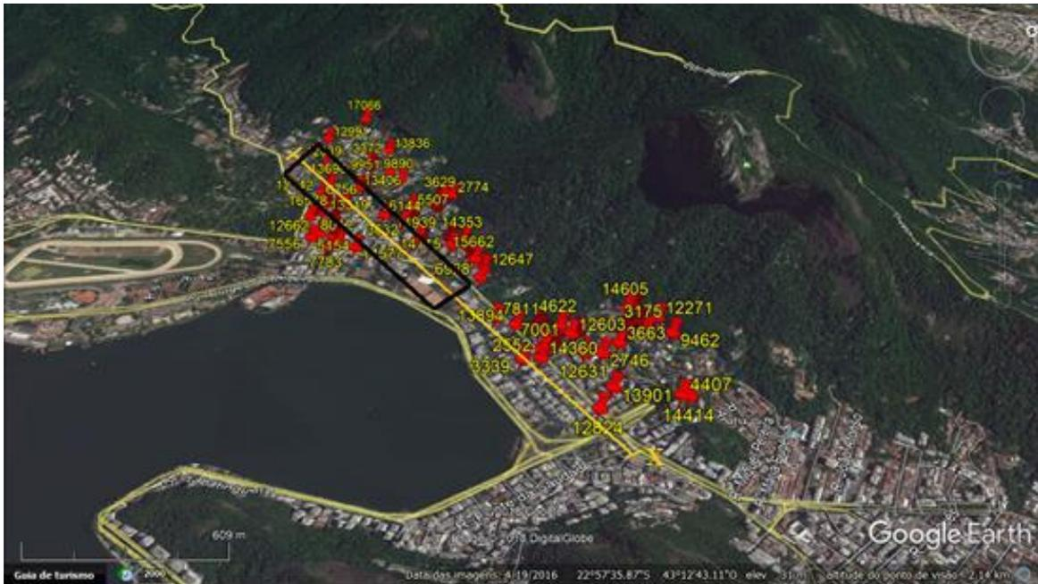
Figura 37: Imagem da disposição dos dados de SPT do Bairro Jardim Botânico. Em amarelo está demarcada a seção onde foi feito o corte X da malha maior da simulação gerada. Em preto está indicada a área da seção dos perfis litológicos gerados através da análise descritiva dos perfis de sondagem SPT.
