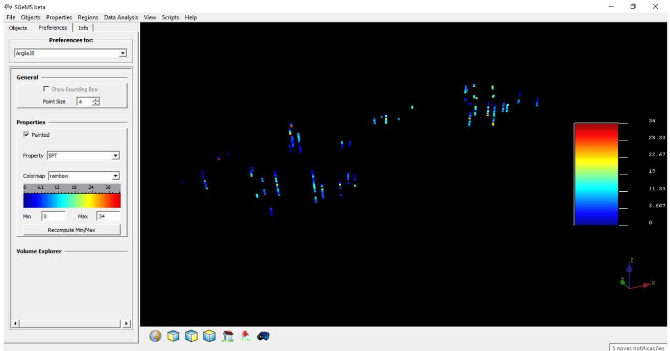
Figura 22: Dados plotados dos boletins de sondagem em escala ideal para análise e com gráfico de SPT determinado, evidenciando uma de SPT de 0 à 34 na escala.
