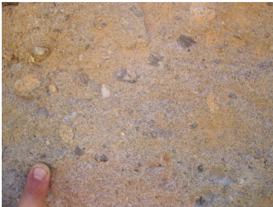
Figura 4.4.: fácies Smc, arenito maciço com clastos angulosos e subangulosos dispersos em matriz siltosa-arenosa, mal selecionada. Na figura é mostrado a heterogeneidade da composição dos clastos, quartzosos, líticos e feldspáticos (vide mapa na figura 3.1A).
