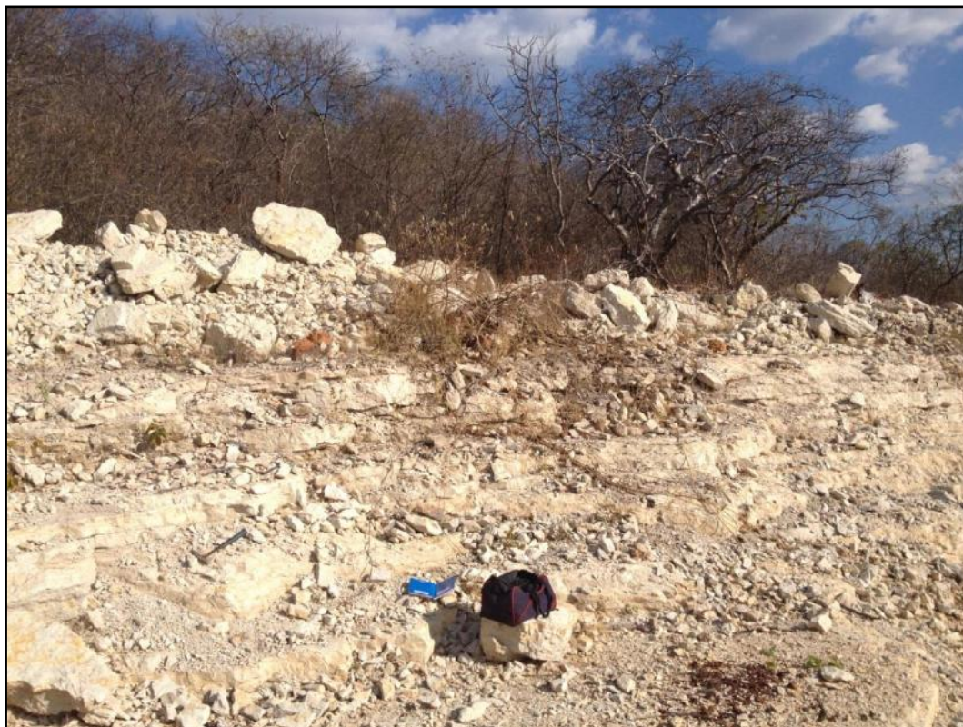
Figura 3.6.: Arenitos finos e siltitos brancos da Formação Tianguá. Corte da rodovia PI-258 no município de Domingos Mourão (PI). Ponto PC-CE-14 (vide mapa na figura 3.1).
