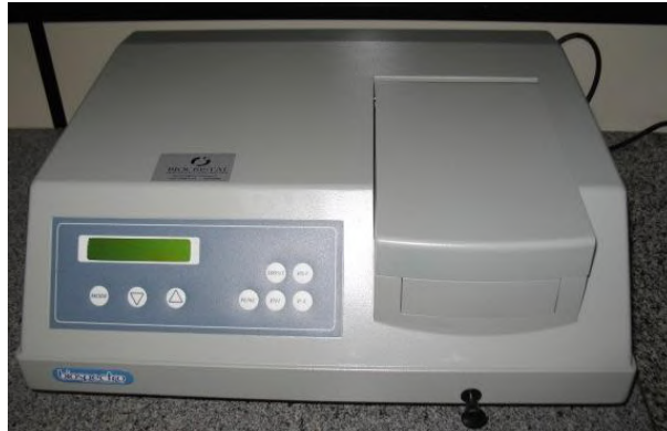
Figura 4.5. Espectrofotômetro Biospectro utilizado para quantificar o NFE-10 retido pelas NPPS.
