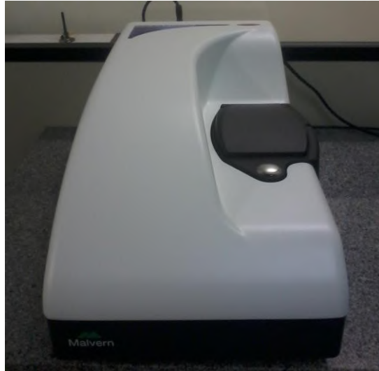
Figura 4.3. Zetasizer Malvern utilizado para determinação do diâmetro médio das NPPS por meio da técnica de PCS.
