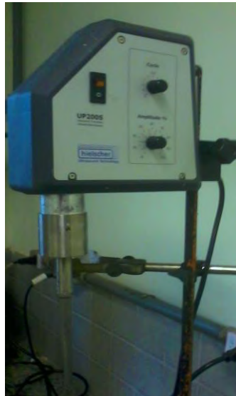
Figura 4.4. Sonicador Hielscher utilizado para re-suspender as NPPS em água e em heptol.
