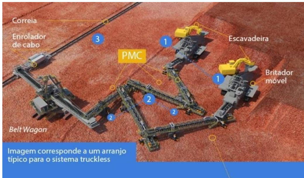
Figura 7: Imagem do Sistema Truckless. 1 – Britador Móvel, 2 – PMC recebe e transporta até as correias, 3 – Correias transportadoras (Fonte: Vale.com.br).
