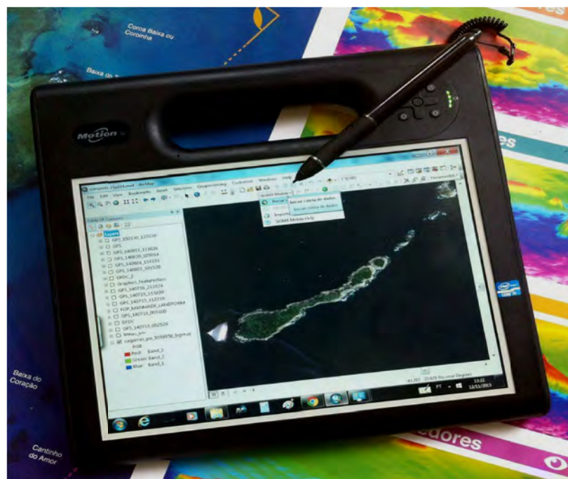
Figura 6 - Tablet robusto de campo Motion F5t com a interface do ArcMap e a extensão SIGMA Mobile ativa e imagem GeoEye-1 com enquadramento na Ilha Comprida. Foto: Jhone Araújo 12/11/2015
