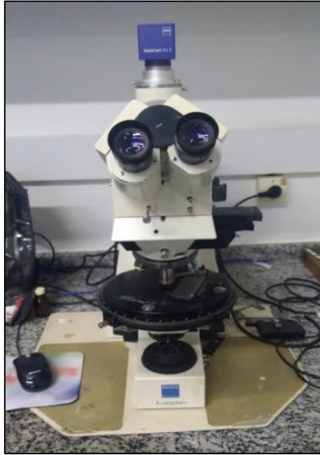
Figura 10: Microscópio petrográfico utilizado para descrição das lâminas delgadas do de ankaramito.
