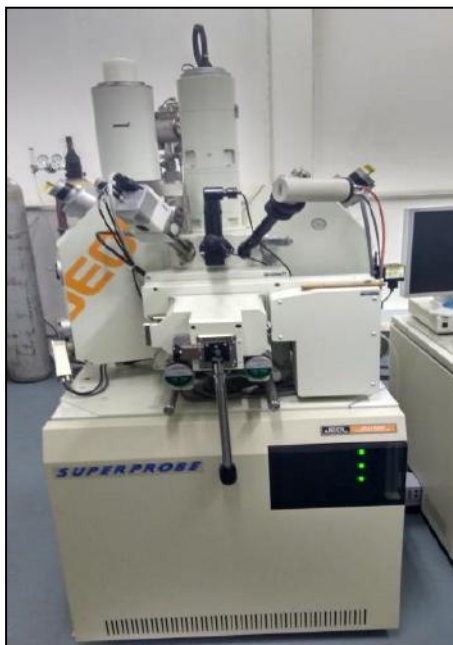
Figura 15: Microsonda Eletrônica utilizada na análise da cromita de Itaboraí.
