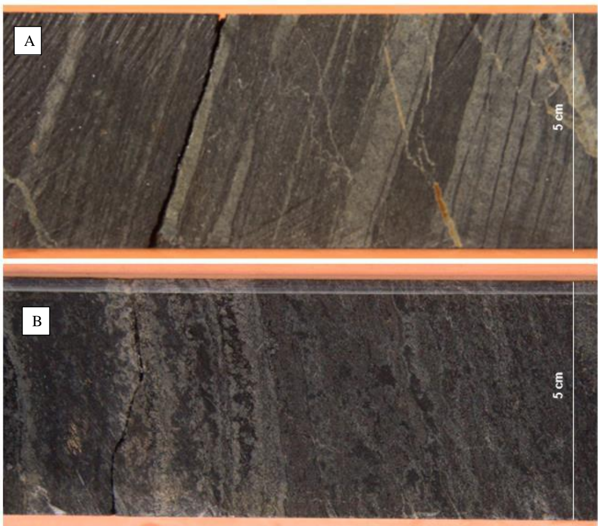
Figura 24 - Fotografias de testemunhos de sondagem mostrando formações ferríferas bandadas do alvo São Francisco. (A) BIF pouco sulfetado com veios de carbonato associados (Furo FSF005 - 162m; (B) BIF em associação com filito carbonoso rico em clorita e granada alterada (Furo FSF006 – 349m).
