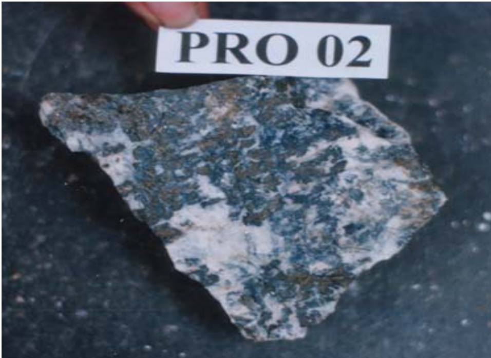
Foto XIII: : Trifilita (mineral verde) sendo substituída por lazulita (mineral azul) em paragênese mineral com albita e mica branca.
