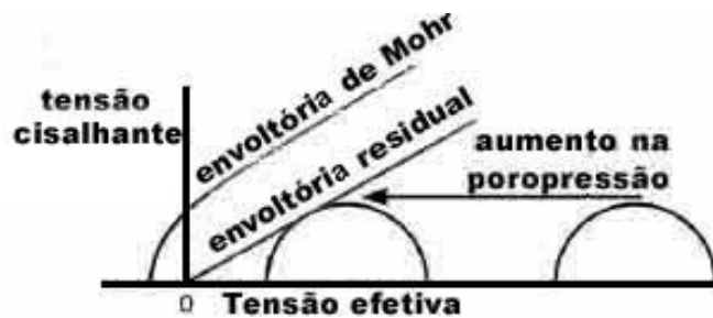
Figura 5 – Efeito da pressão de poro reduzindo a resistência da rocha selante (Streit 2002).
