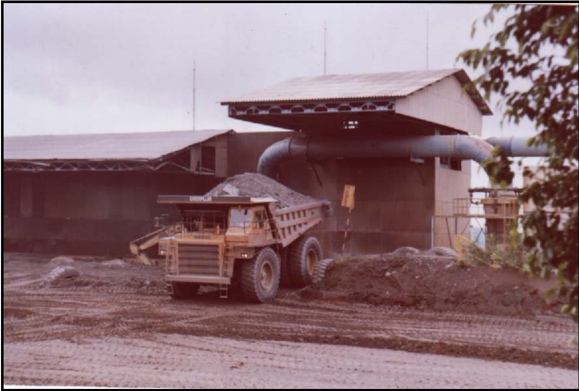
Foto 2 – Caminhão Catterpillar modelo CAT 777 com capacidade de 100t, despejando minério na usina de beneficiamento, passando pela primeira etapa de britagem.
