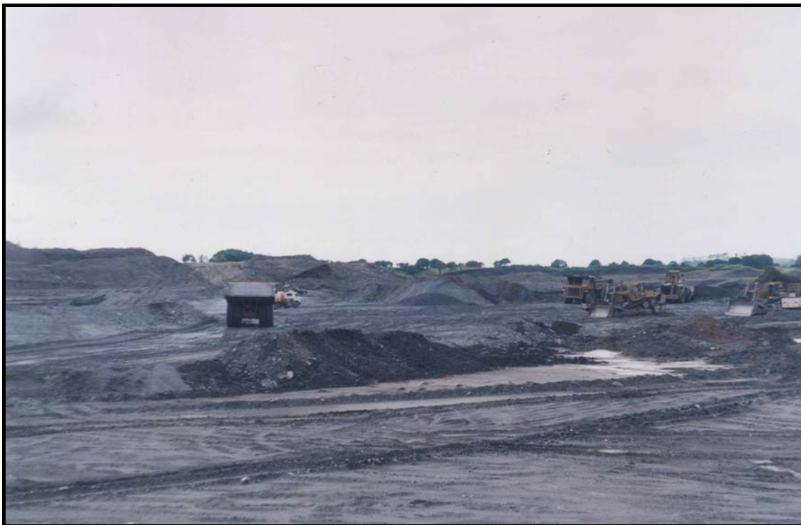
Foto 1 – Operação da lavra, com os caminhões fora de estrada, carregadeiras e os tratores de esteira. Nesse processo é controlada a quantidade de caminhões que chegam a britagem com o minério sulfetado e o oxidado (menor teor), a fim de obter a blendagem, ideal.
