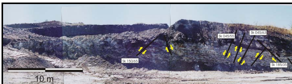
Foto 9 (Mapa 2 - Dominio 1) - Frente de lava no nível 724m no bloco 411 onde se lê 4 para Norte e 11 para Oeste. O local apresentava grandes quantidades de boudins de quartzo porém pouco sulfetados, a direção de elongação dos boudins (“E”) obedece uma direção para sul, totalmente fora do que foi representativo para a região da mina mostrado acima. As superfícies de kinks (Sk) mostram forte tendência para mergulhar NE.
