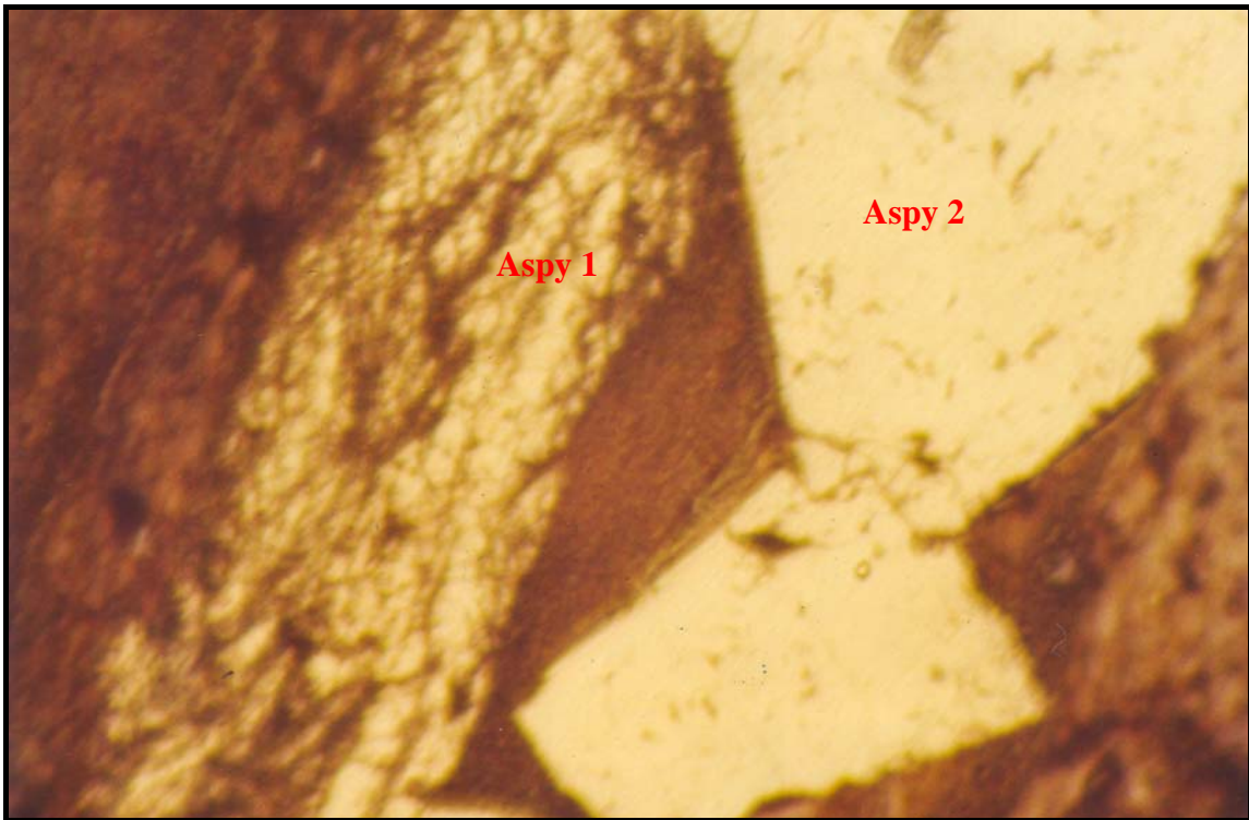
Foto 29-(MRO-30) Foto tirada em microscópio eletrônico com luz transmitida onde é possível observar a existência de duas arsenopiritas, primeiramente uma mais antiga (Aspy 1), com uma orientação mais marcada pela direção de xistosidade, e outra mais nova gerada através da recrystalização (Aspy 2).
