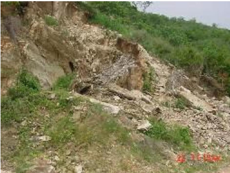
Foto 2: Aspectos de uma pedreira abandonada. A falta de estudos geológicos e planejamento de lavra acabam ocasionando nessas frentes paralisadas, onde muitos recursos foram mal aproveitados e, além disso, não há compromisso de recuperação do passivo ambiental.
