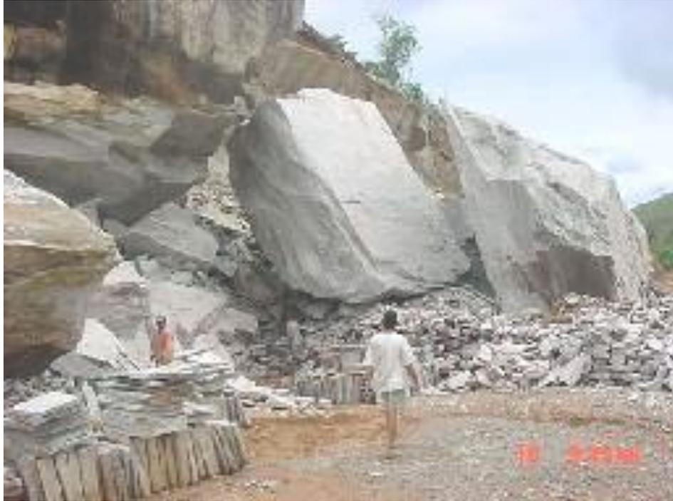
Foto 13: Falta de planejamento na lavra – pedreira localizada no bairro Café Garoto. A utilização inadequada de explosivos ocasionou a queda dos blocos (soltos, na foto). Por sorte, não havia ninguém na área de trabalho quando ocorreu a queda dos blocos.
