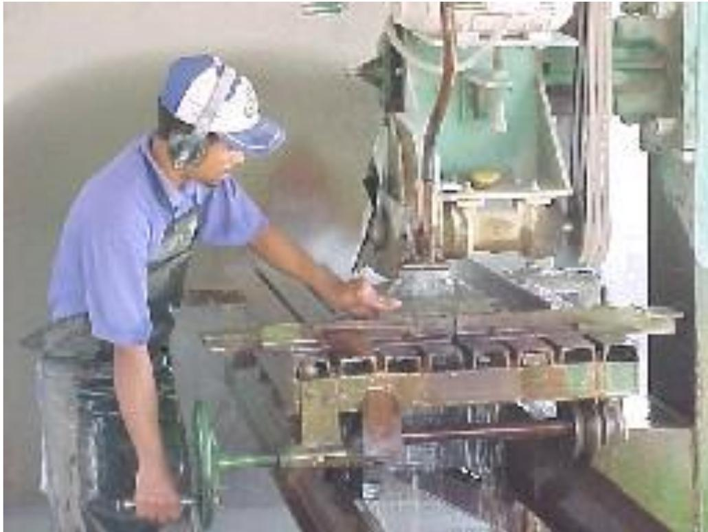
Foto 27: Lajes sendo desdobradas em “cubos”. Notar a posição da mão do operador, próxima ao disco de corte, em situação de risco de acidente.
