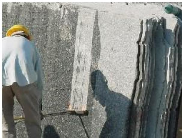
Foto 39: Processo de flamagem de chapas – através do uso de um equipamento denominado “flameador” (gás GLP como combustível), a chapa é “queimada”, proferindo um aspecto rugoso, antiderrapante, ideal para ambientes externos.
