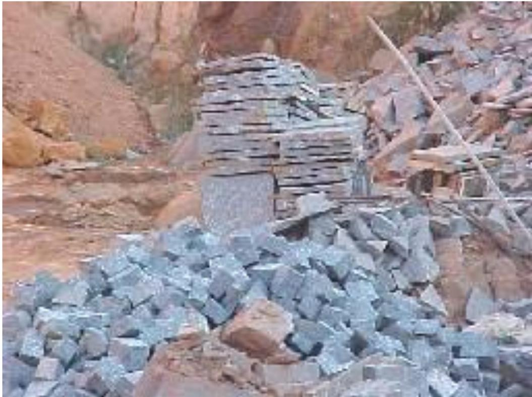
Foto 25: Lajes e paralelepípedos, prontos para carregamento.
