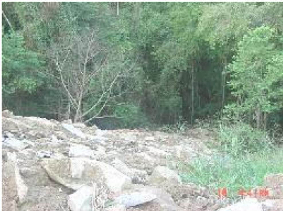
Foto 16: Disposição inadequada de rejeitos de lavra. O bota-fora da pedreira avançou para uma área vegetada. Localidade: Serra dos Blanc.
