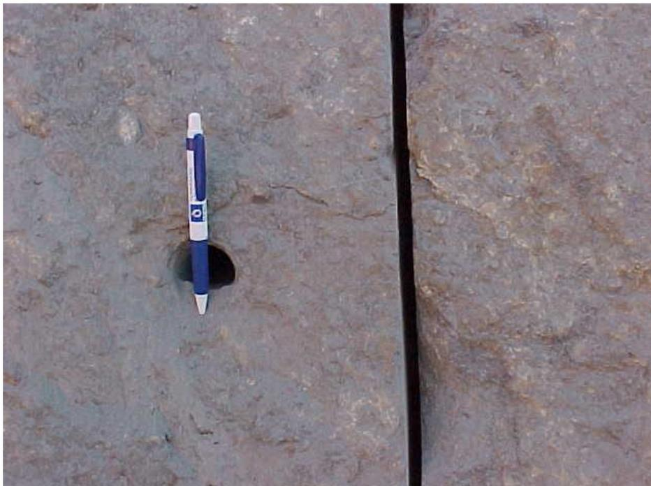
Foto 7: Detalhe mostrando largura do corte com fio diamantado e diâmetro da perfuração para uso de explosivos.
