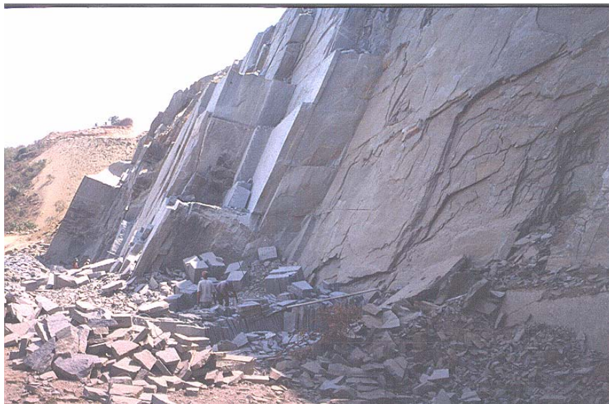
Figura 44: Bloco desmontado do maciço e desdobrado em blocos menores.
