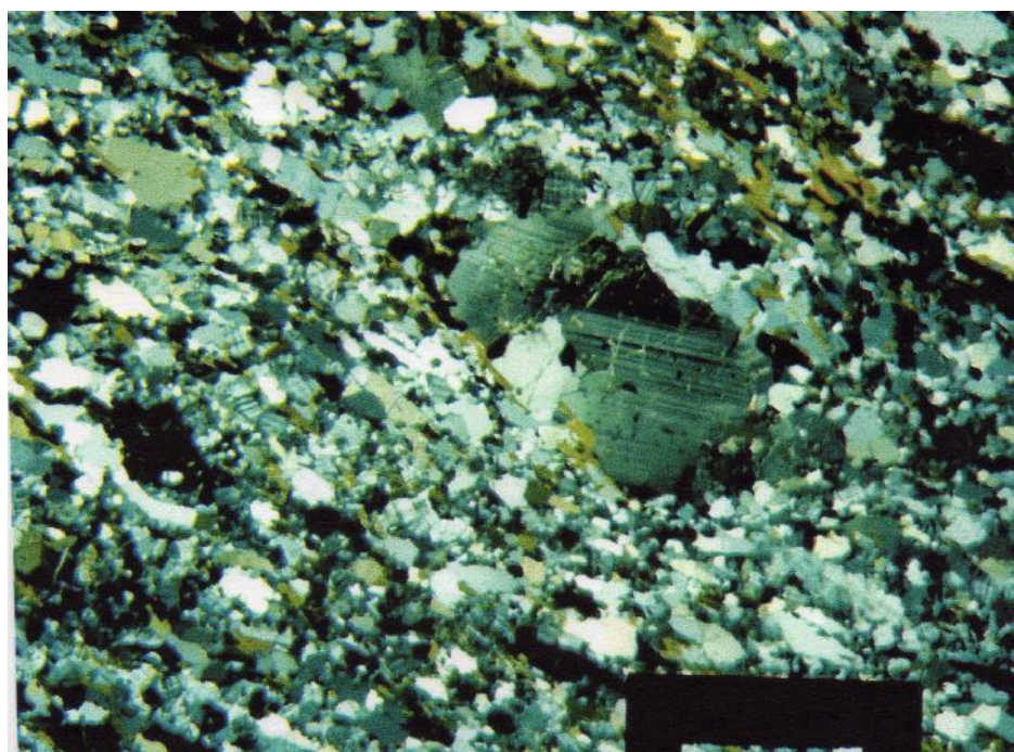
Figura 21: Porfiroclásto de plagioclásio com geminação polissintética imerso na matriz.
