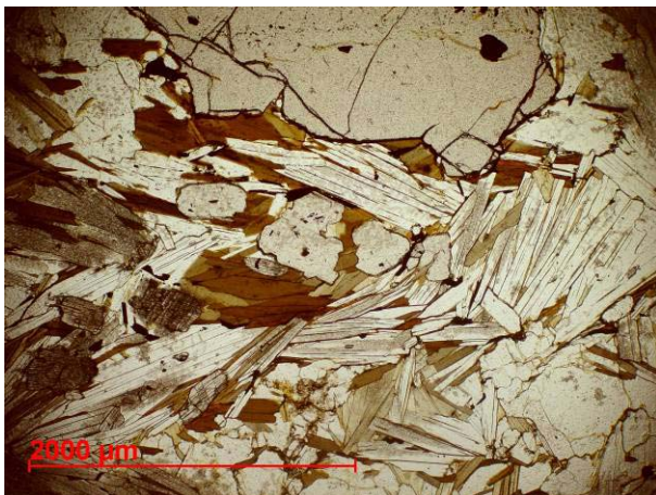
Fotomicrografia 3.3a: aspecto geral do granada muscovita xisto. A foliação, marcada pelas micas, deflete na borda da granada. No canto esquerdo, alguns cristais de cianita com a clivagem característica desse mineral (lâmina FMM-027, Anexo III).
