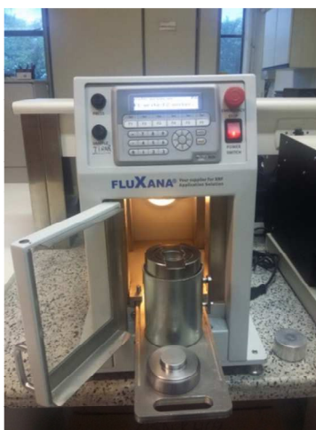
Figura 13: Prensa automática FLUXANA modelo VANEON.
