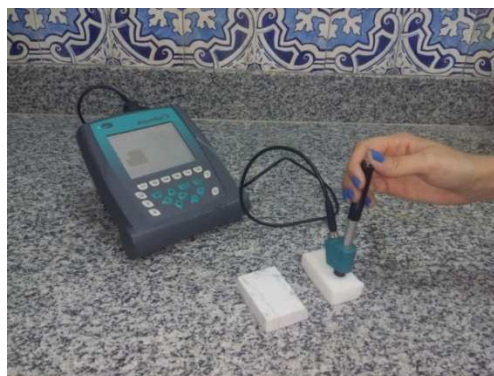
Figura 24: Fotografia do aparelho portátil Equotip 550 medindo a dureza de amostras de mármore brasileiro e mármore Carrara sãos que foram utilizados para estabelecer um padrão.
