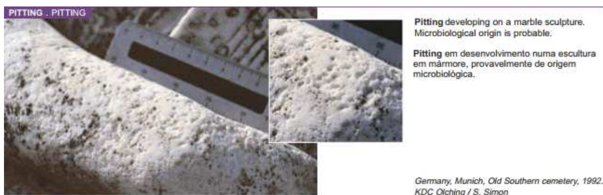
Figura 10: Exemplo de pitting em escultura de mármore (ICOMOS, 2008).
