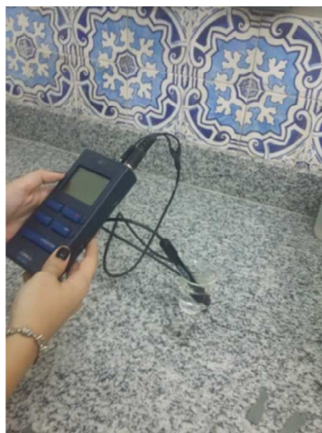
Figura 17: pHmetro do modelo digital DH-22 da marca Digimed.
