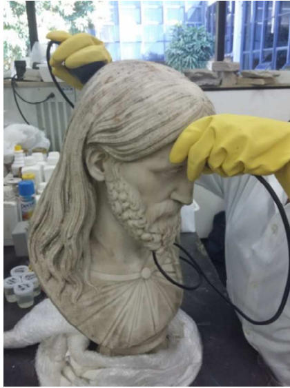
Figura 27: Medição da velocidade ultrassônica utilizando o aparelho Pundit PL-200.
