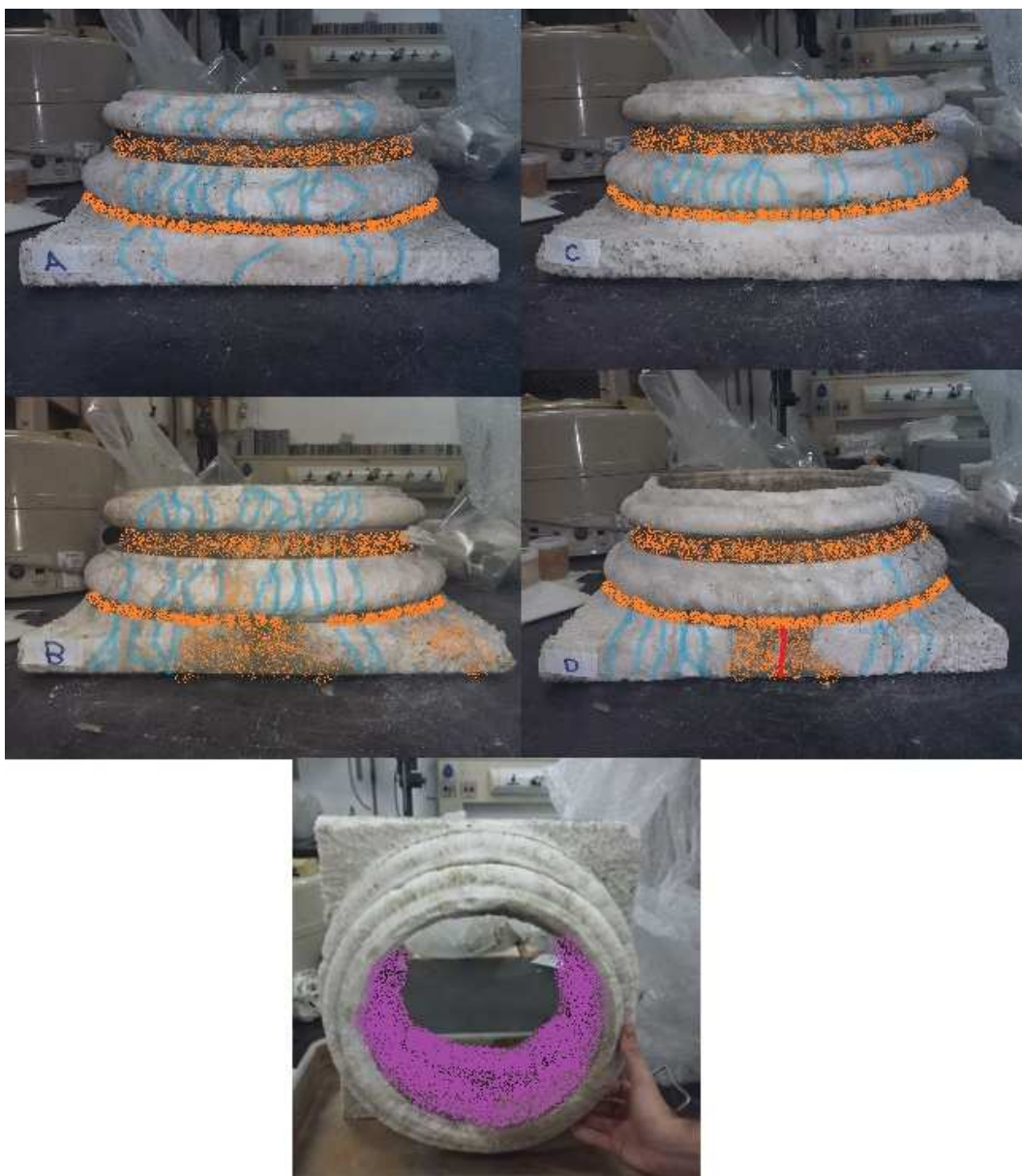
Figura 31: Mapeamento de danos realizado no adorno quadrado.
