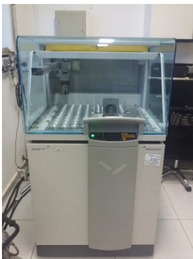
Figura 14: Espectrômetro por fluorescência de raios-X PANALYTICAL modelo AXIOS MAX.
