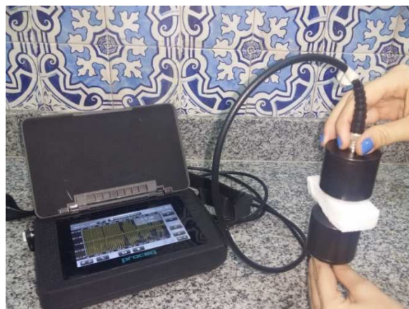
Figura 29: Ensaio de velocidade ultrassônica realizado em uma amostra de mármore são.
