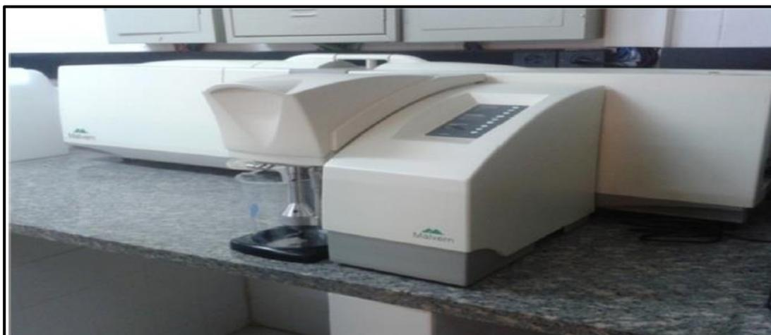
Figura 35 – Equipamento de difração a laser da marca MalvernMastersizer 2000 utilizada no presente trabalho.
