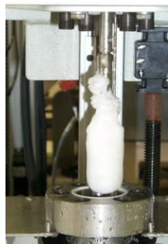
Figura 9. Hidrato de metano formado em um teste com água destilada, na Autoclave Engineers
