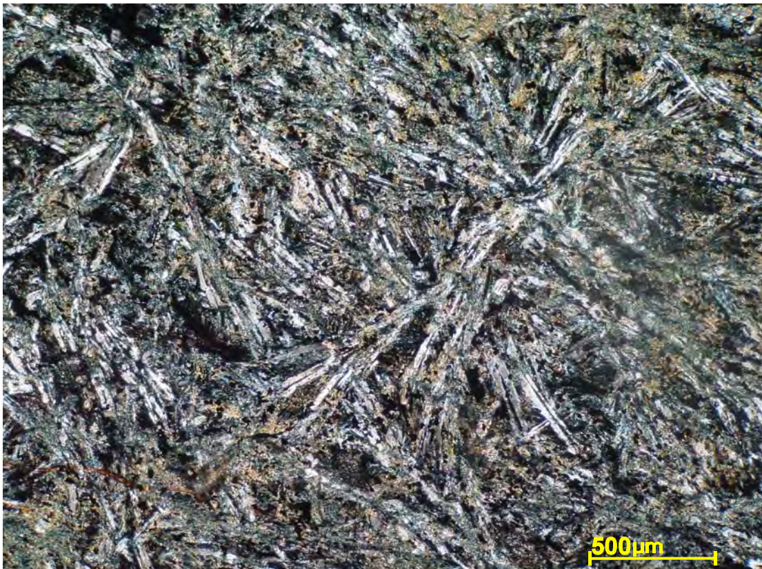
Figura 47: Aspecto textural do basalto. Observa-se plagioclásio formando textura Plumosa, consequência do rápido resfriamento.(VAC-56). Nicóis Cruzados.
