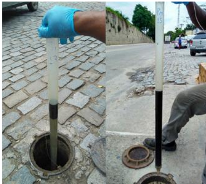
Figura 5. Fase livre não aquosa encontrada nos poços de monitoramento.
