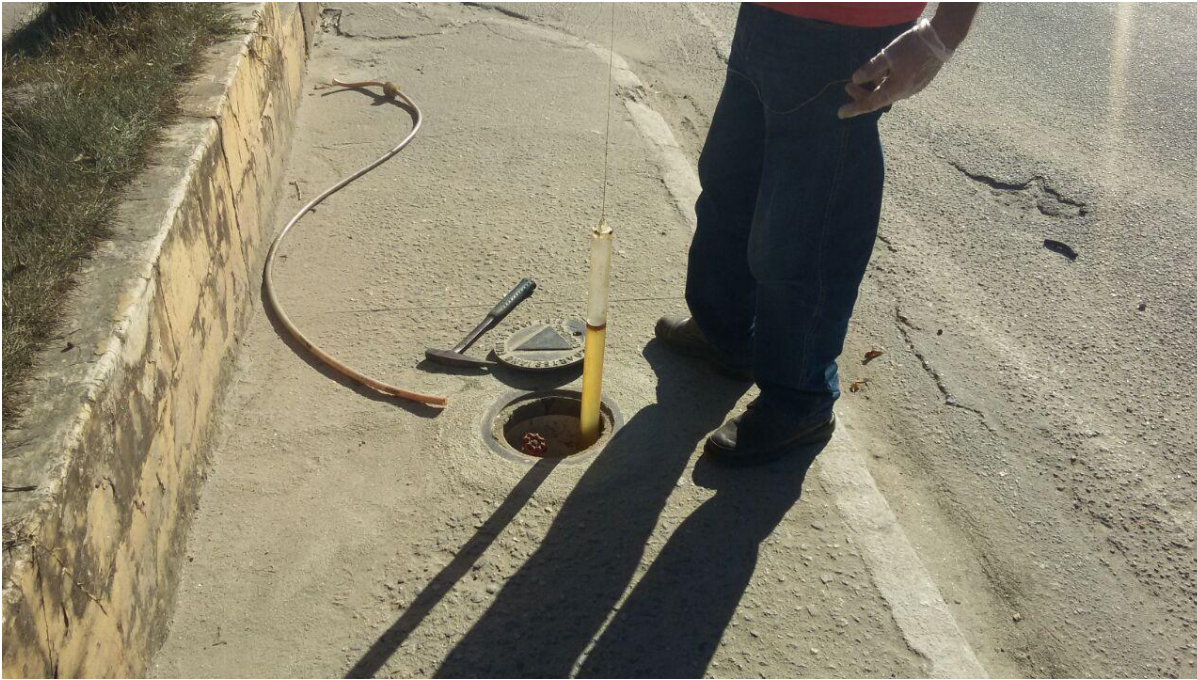
Figura 15. Fase livre remanescente no PM-04 após dois meses de bombeamento.
