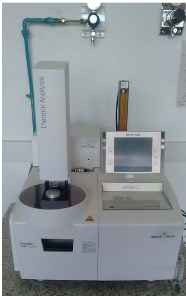
Figura 27. Analisador termogravimétrico modelo Mettler Toledo STAR c System com fluxo de gases controlado.
