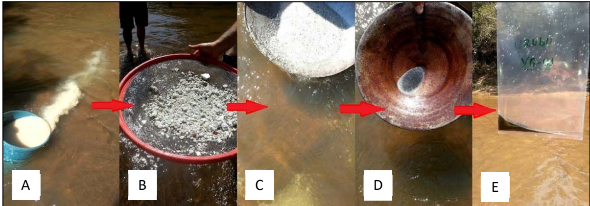
Figura 16. Fase realizada para a obtenção do concentrado de minerais pesados a partir de saprólitos de pegmatitos. A: Processo de deslamagem; B: peneiramento; C e D: concentração de minerais pesados em bateia; E: produto final (concentrado de minerais pesados).
