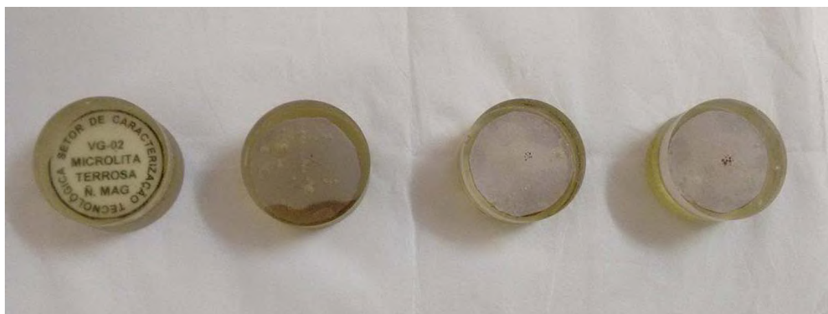
Figura 23. Grãos embutidos em resina epóxi (seções polidas).
