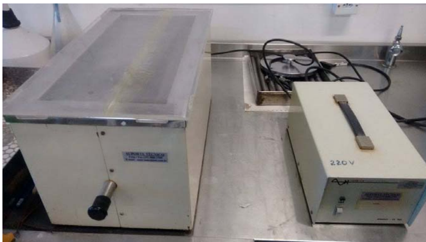
Figura 18. Ultrassom do Centro de Tecnologia Mineral utilizado para liberação de finos e impurezas dos concentrados de minerais pesados.
