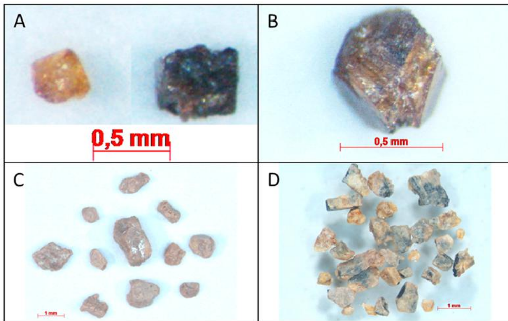
Figura 32. Grãos de microlita: A – euédricos inteiros; B – subédrico; C – anédricos; D – pseudomorfo de minerais do grupo da columbita-euxenita.
