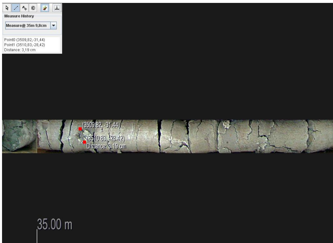
Figura 37 – Área de visualização do Corelyzer , exibindo a janela Measure History , com os dados das coordenadas do Ponto0 e Ponto1 e o tamanho da concreção em distance .
