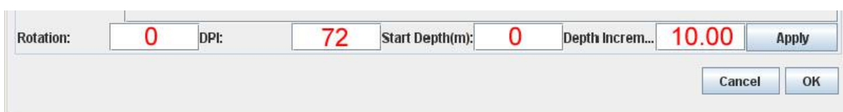
Figura 18 – Exemplo do preenchimento na última linha, na janela “ Load Images with Properties ”, caso as imagens inseridas, tenham comprimento acima de 1.00 m.
