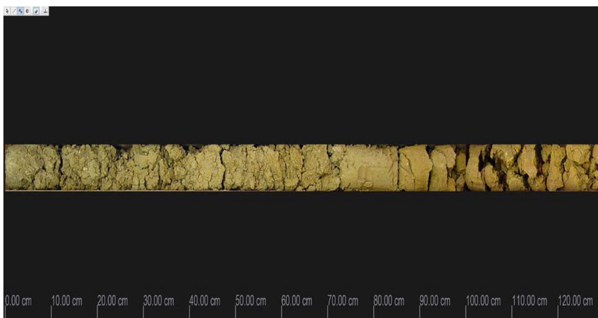
Figura 17 – Foto do poço PINDA-1-SP, inserida na área de visualização do Corelyzer ; no intervalo 0.00 a 125.00 cm. Na parte inferior nota-se a régua (em centímetros) indicando o aumento da profundidade para direita.
