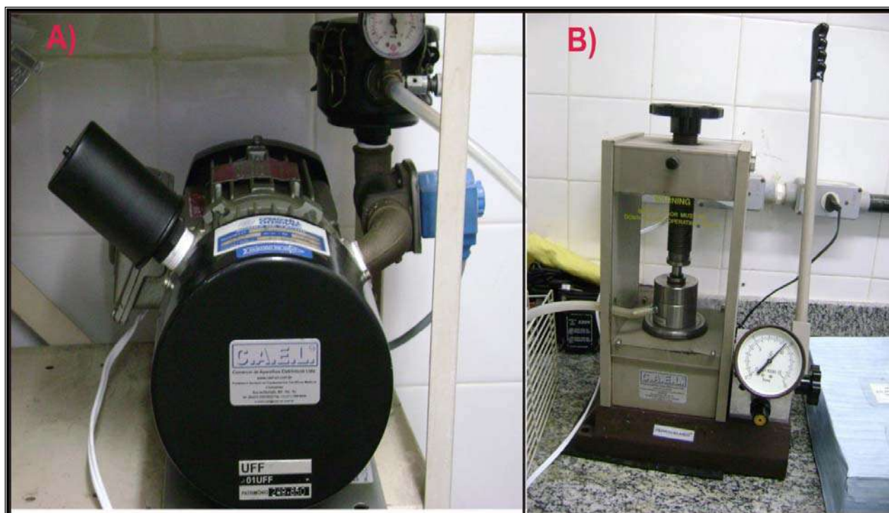
Figura 24 – Equipamentos usados para confecção das pastilhas: A) Bomba de vácuo e B) Prensa hidráulica manual de marca Perkin Elmer
