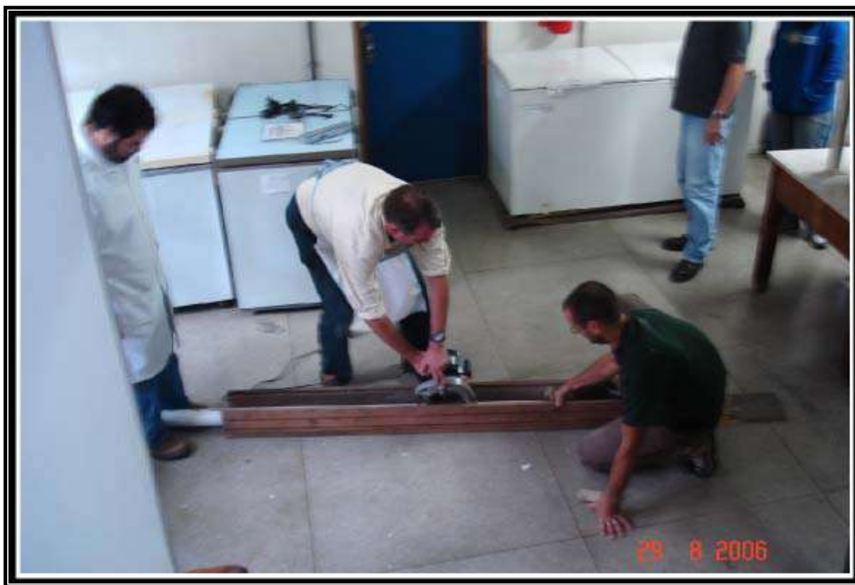
Figura 13- Procedimento da abertura do testemunho, com o corte longitudinal do testemunhador. Nota-se a “caixa de abertura” como suporte e guia. A esquerda Maurício Domingues auxilia no processo. Fonte: Fermino (2007).
