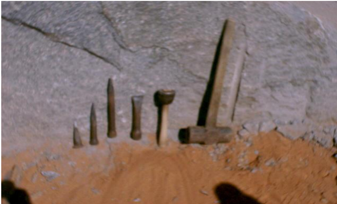
Foto 02: Instrumentos utilizados na extração dos blocos do maciço
