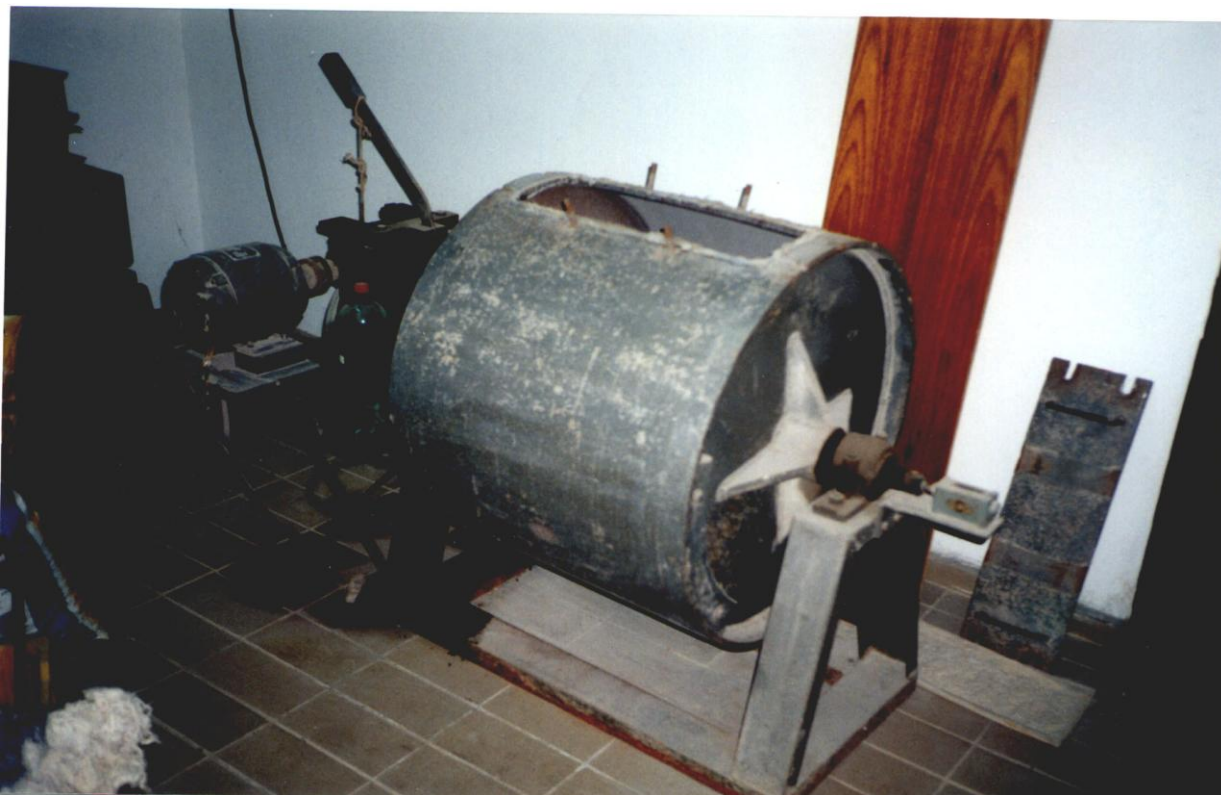
Foto 18: Tambor para realização do ensaio de Abrasão Los Angeles
