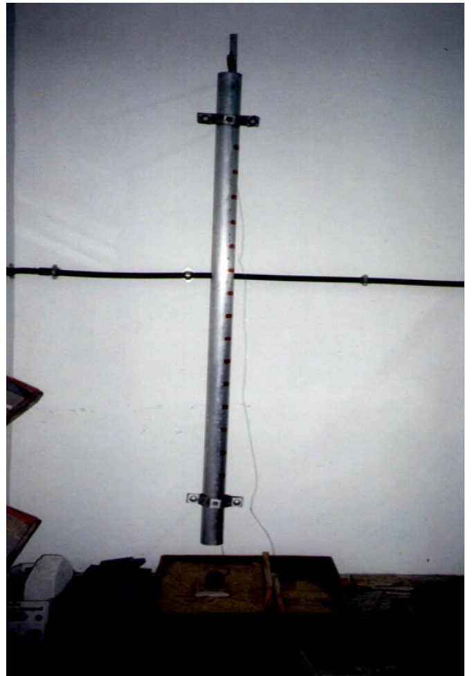
Fotos 16 e 17: Vista do ensaio de resistência ao impacto de corpo duro.
