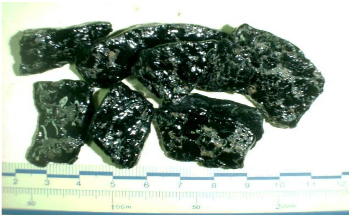
Foto 15: Vista da amostra de “ Pinta Rosa “ sem DOPE. Resultado insatisfatório.
