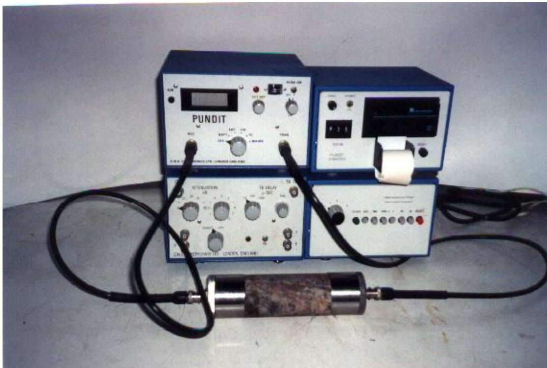
Foto 19: Conjunto de aparelhos utilizados para a medição do tempo de propagação de ondas elásticas.
