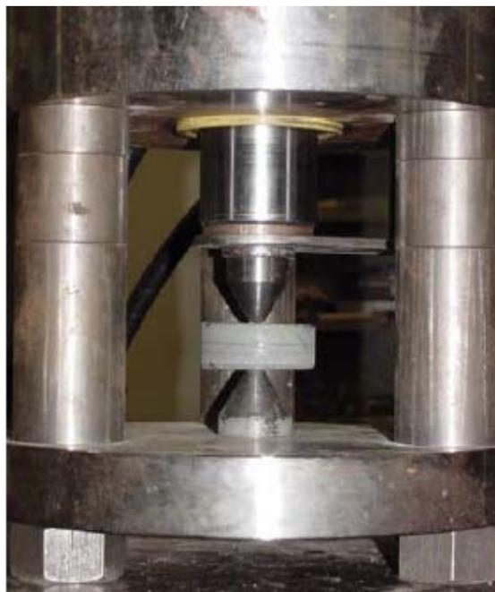
**Figura 4.15** – Ensaio de carga pontual (CP) (Pehovaz-Alvarez et. al., 2004).
