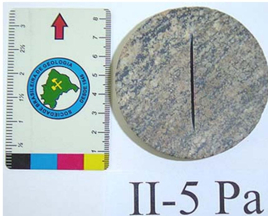
**Figura 5.8** – Corpo de prova com corte orientado a 45° em relação à foliação.
