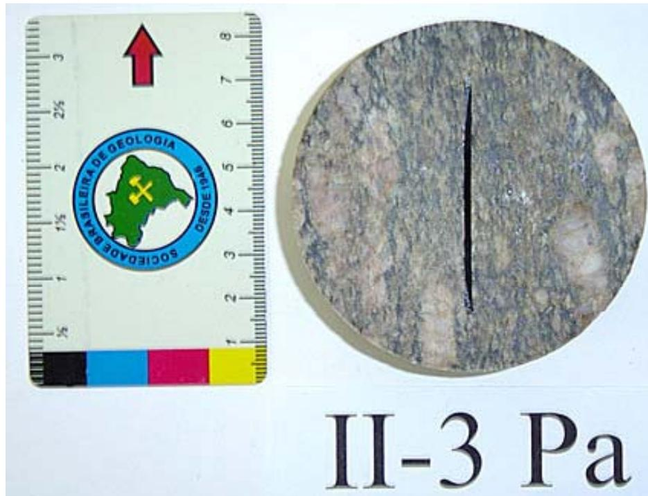
**Figura 5.7** – Corpo de prova com corte paralelo à foliação.
