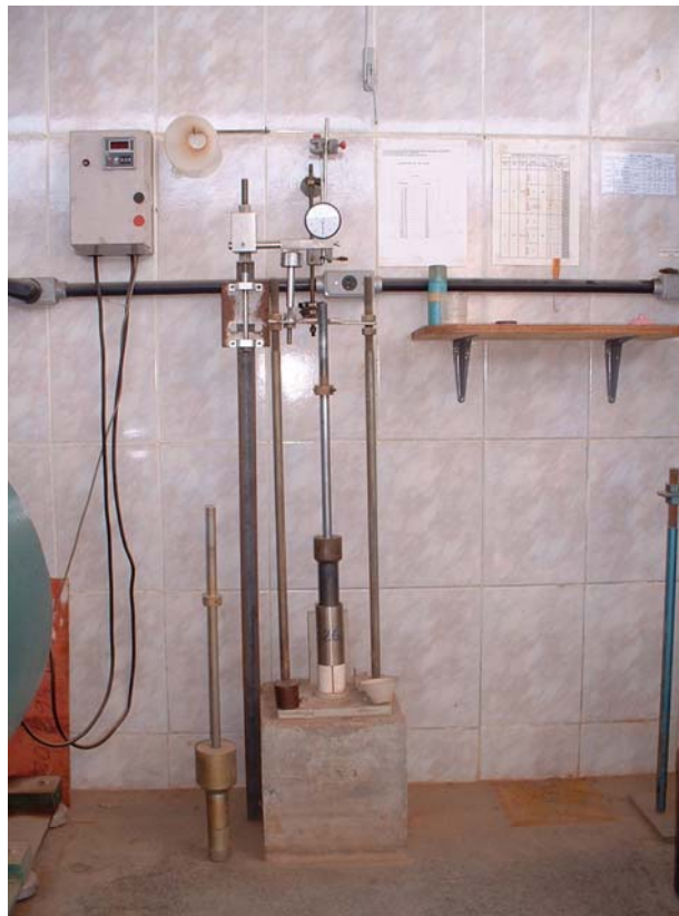
Foto II. 1: Equipamento de compactação, utilizado na Metodologia MCT de classificação dos solos, da COPPE – UFRJ.
