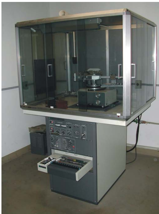
Foto II. 3: Aparelho para a identificação dos argilominerais, difratômetro de raios-X.
